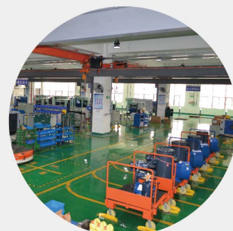
整机自动流水线 结合无人搬运车和自动化轨道输送，有效提升装配效率
